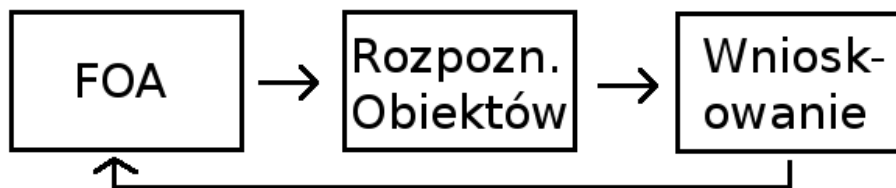
Rysunek 4.2: Propozycja przykładowego systemu sterowania FOA poprzez wnioskowanie o świecie na podstawie nowo zdobytej wiedzy (podsystem rozpoznawania) oraz wiedzy o świecie (podsystem wnioskujący).
