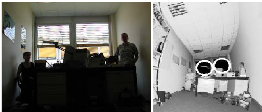
Rysunek 4.3: Zniekształcenia po bezpośrednim nałożeniu danych z laserowego skanera odległości na raster 2D – porównanie z kamerą wizyjną (zaczepnięte z [45]).
