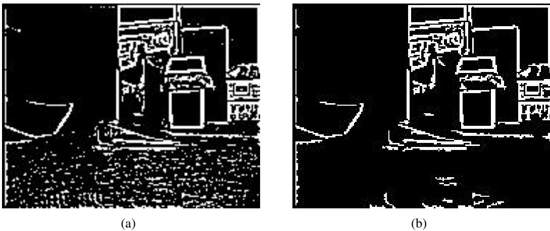
Rys. 2.12. Efekt operacji „denoise” dla obrazu krawędzi „pstrokatej” powierzchni: (a) obraz wejściowy oraz (b) obraz wyjściowy.
